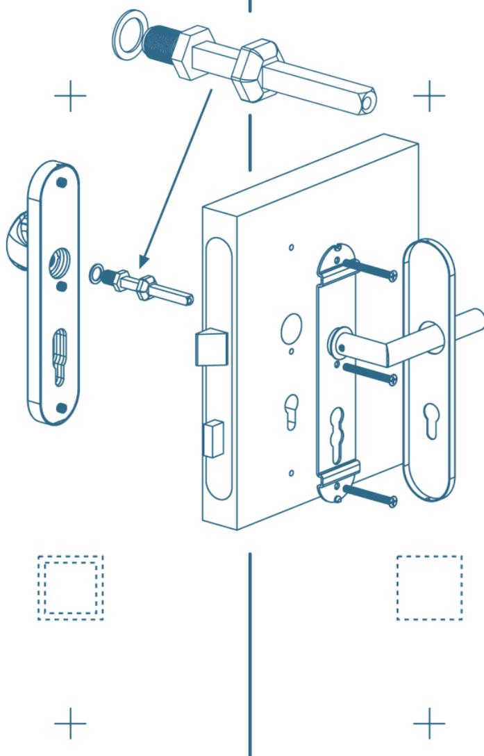
**1.** Umseitige Bohrlehre auf dem Profilzylinder und dem Vierkantstift zentrieren und die Befestigungsbohrungen auf dem Türblatt anzeichnen.
